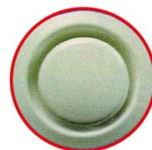
La bouche VMC s'insère directement dans le conduit. Aucune fixation supplémentaire n'est demandée, la bouche VMC est pourvue d'un joint pour éviter les passages d'air parasites et les traces noires. Réglage du débit par rotation de l'obturateur
